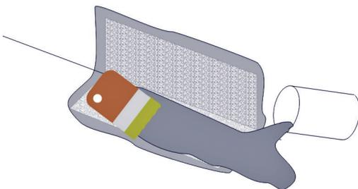
5. Sättigenden Anstrich des Materials (nass in nass) auftragen. Anschließend die Flüssigabdichtung mit dem Pinsel bis zur vollständigen Sättigung verteilen.
