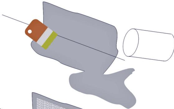
3. Material auf die Reparaturstelle aufgießen und mit dem Pinsel verteilen
